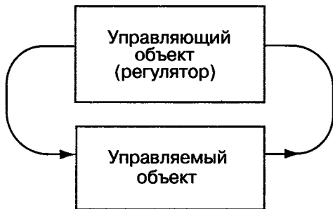
Рис. 5.10 Управление по принципу обратной связи
